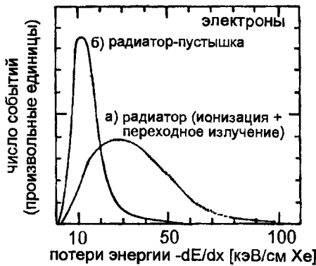
Рис. 6.23: Типичное распределение потерь энергии для электронов высокой энергии в детекторе переходного излучения с а) реальным радиатором и б) радиатором-пустышкой [450].
