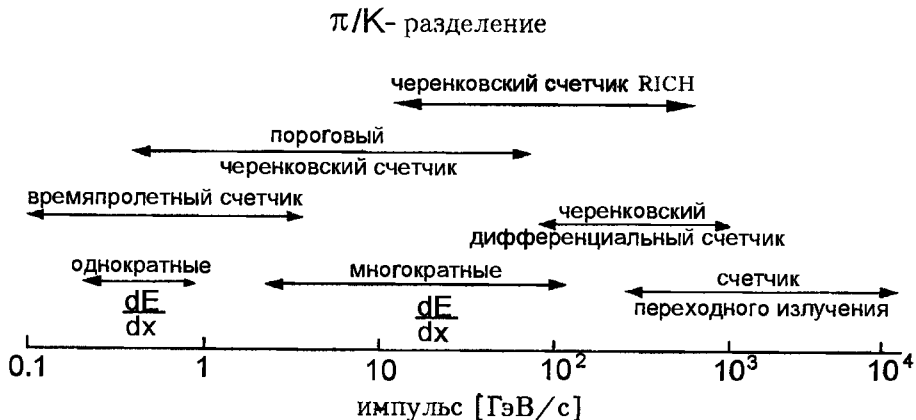
Рис 6.34: Иллюстрация различных методов идентификации для разделения пионов и каонов вместе с характерными диапазонами импульсов
