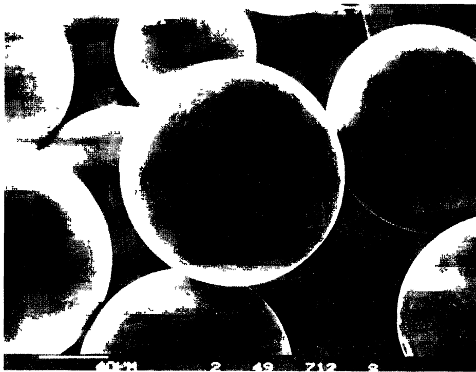
Рис. 7.56: Оловянные гранулы (диаметр = 130 мкм) в качестве криогенного калориметра. Поглощение при низкой энергии может нагреть гранулы на величину, достаточную чтобы вызвать переход из сверхпроводящего состояния в состояние с нормальной проводимостью, обеспечивая тем самым регистрируемый сигнал [590,597].
